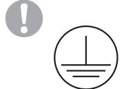
Использование незаземленного оборудования может привести к поражению электрическим током.  Для собственной безопасности отключайте кондиционер от источника питания перед обслуживанием, ремонтом и чисткой, а также если планируете не использовать его длительное время.
