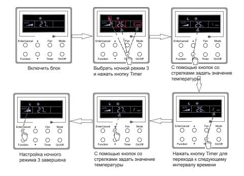
Рис. 13. Настройка графика изменения температуры в ночном режиме 3
