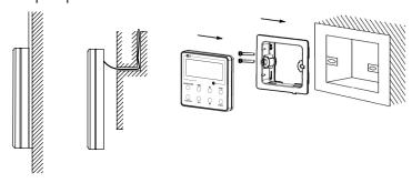
2) Подключите сигнальный кабель к 4-штырьковому разъему на обратной стороне пульта и установите его согласно пунктам установки на рисунке ниже.
